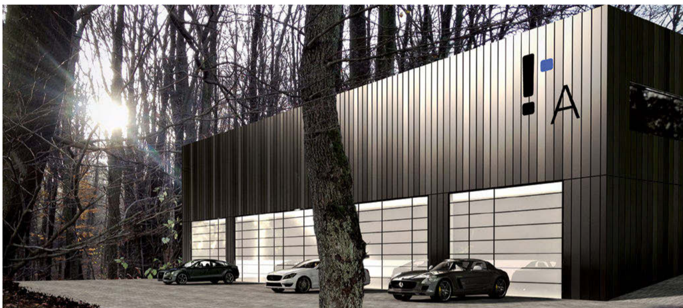
Oben: Das Architekturbüro PASD aus Hagen entwarf das Gebäude und betreut auch das Bauvorhaben. Die Konstruktion ist ein Stahltragwerk auf Stahlbetonmassivbau, die Fassade eine Metall-Paneelfassade. Die Geschossfläche beträgt ca. 643 m 2 . Bildquelle: PASD
