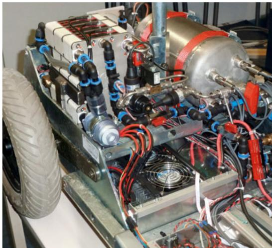
am Standort Soest und das Institut für Technologie- und Wissenstransfer TWS der Fachhochschule Südwestfalen haben Elektrohybridantriebe auf der Basis von PEM-Brennstoffzellen in Kombination mit Batterien für Anwendungen in kommerziellen Scootern und Klein-PKW entwickelt.
