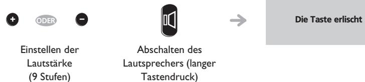
ein kurzer Druck auf die Lautsprechertaste ermöglicht den Übergang in die Betriebsart Freisprechen (Anzeige leuchtet ständig).
