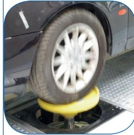
Vertikalanregungen bis zu 25 kN und ca. 100 Hz werden durch vier Zylinder, die auf einem luftgefederten Schwingfundament angeordnet sind, in das Fahrzeug eingeleitet.
