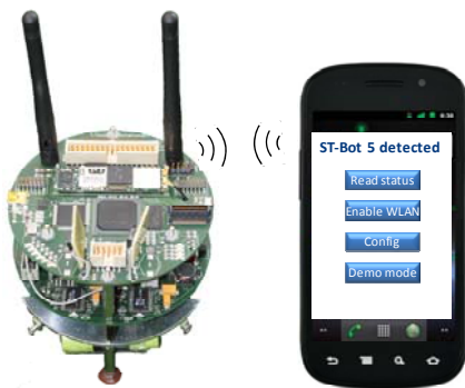
Miniaturroboter und Smartphone tauschen Daten per NFC aus
