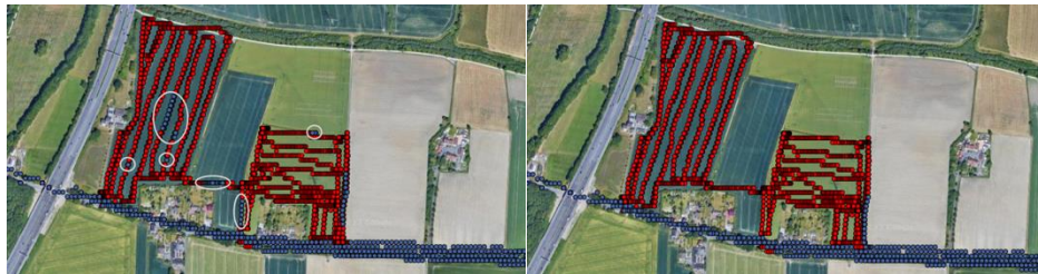
Abb. 3: Fehlerhaft geclusterte Datenpunkte (links). Verbesserung durch Klassifikationsalgorithmus (rechts)
