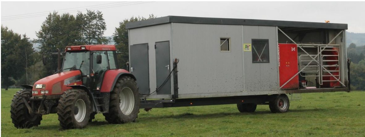
Abbildung 4: Transport des Automatischen Melksystems im Container
