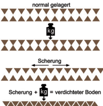
Wirkungsschema von Scherung (Schlupf) und Gewicht auf die Bodenteilchen
